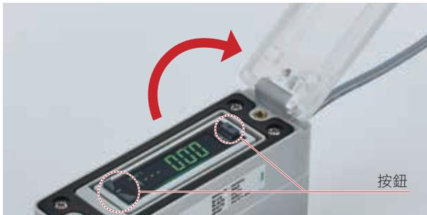
LCD顯示型在打開護蓋後即可操作按鈕。
