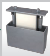
⑰ 插入電池盒 將捲繞後的材料插入電池盒。
