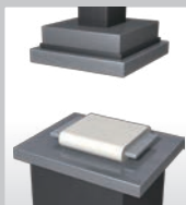
⑮ 壓合 壓合捲繞後的元件。
