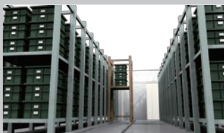
22 熟化 將充飽電的電池在指定溫度下放置一段時間。
