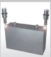
⑱ 焊接電池盒蓋 使用雷射焊接電池盒與盒蓋。
