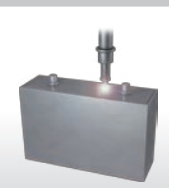
⑳ 焊接注液栓 焊接注液栓，將電池完全密封起來。
