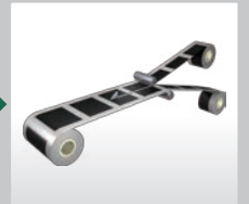
⑥ 裁切 將成卷的電極材料和隔離膜切割成適當大小。
