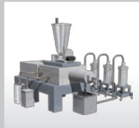
④ 測量、混合 量取適量正極、負極材料並混合成漿狀。
