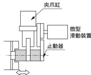
註)由於工件在小夾爪上滑動，夾爪缸的壽命可能會大幅縮短。請務必充分考量小夾爪的形狀。
