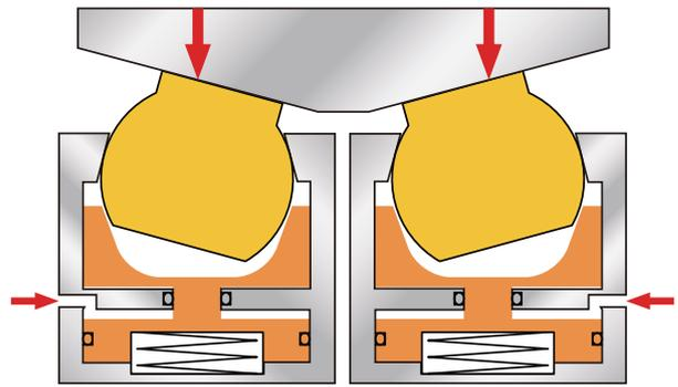
3 空氣排除時鎖定。配合工件的傾斜面倣形，保持位置。
