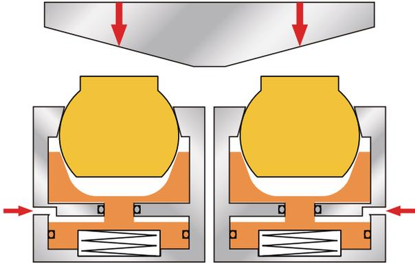
2 工件推壓，傾斜面倣形。
