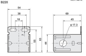
重量: 0.15kg 材質: 鋼 鍍鋅處理
