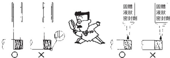
當使用液狀密封劑時，請加以注意，避免附著在塑膠杯上。塑膠杯可能破損，非常危險。
