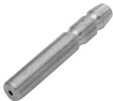
該噴嘴主要用於檢出物體是否存在，所以其測量距離比前面介紹的3種噴嘴更長。使用方法係使噴射噴嘴B與檢出用噴嘴A相對，利用噴嘴間有物體時及沒有物體時的壓力變化檢出是否有物體存在。一般，該型噴嘴的檢出側噴嘴內徑與噴出側噴嘴內徑相同，或者較噴出側噴嘴內徑大。
