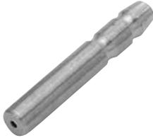
測量用噴嘴幾乎均為圓形。其測量距離與流出面積的關係為 $X \leq \frac{d}{4}$  (d: 檢出用噴嘴內徑、X: 與檢出物的距離)，可使用於較短的間隙距離。且最適合的內徑為1~2mm (APA4-BA10或APA4-BA20)。
